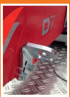
Haken und Ösen sind aus hochfestem Stahl gefertigt. Sie werden mittels Bolzen in den vorgefertigten Löchern an den Schemelkörpern montiert.
