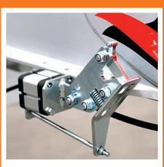
Der Vorteil eines pneumatischen Auslösers besteht darin, dass der Fahrer nicht aussteigen und die Verzurrungen nicht mehr einzeln lösen muss. Mit einem einzigen Handgriff lassen sich die Verzurrungen von der Kabine aus an allen Stapeln gleichzeitig lösen. Wurde die Verzurrung gelöst, rollt sich der Gurt automatisch auf. Einfach und flexibel. Muss nur an einem Stapel die Verzurrung gelöst werden, erfolgt dies nach wie vor per Drahtseilauslöser.
