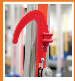
Der Haken ist so ausgelegt, dass er sich einfach per Greifer anheben lässt. Sowohl der Haken als auch der Halter sind aus strapazierfähigem Spezialgummi gefertigt. Die Halterung lässt sich einfach an der Runge montieren. Die Konstruktion hält den Haken auch während der Fahrt stabil. Der Haken erhöht als ergonomische Lösung die Sicherheit und beschleunigt das Verzurren.
