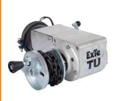
Auf dem Holzwagen wird der TU-Spanner am Schemel oder Rahmen montiert. Die symmetrische Konstruktion (rechts bzw. links) erlaubt je nach Erfordernissen eine Anbringung von Gurttrommel und Ausrückhebel auf jeder Seite. Der TU-Spanner wurde zur Sicherung von Lasten für alle Schwertransporte (Holz oder andere Güter) konzipiert. Das pneumatische Lösen des Spannermechanismus ist als Zubehör erhältlich. Das Lösen kann somit per Knopfdruck von der Lkw-Kabine aus erfolgen.
