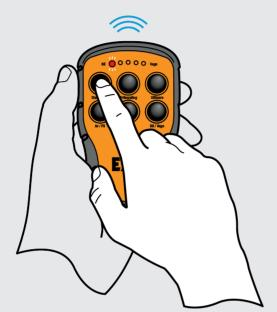
Wenn Sie bereit sind zur Abfahrt, drücken Sie auf "Start". Die Zurrvorrichtungen ziehen etwaigen Durchhang ein, sodass die Ladung niedergezurrt wird. Während der Fahrt zur Entladestelle sind die Zurrvorrichtungen aktiv und spannen die Ladung bei Bedarf nach.
