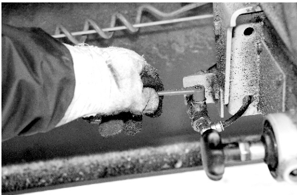
9.5 Lossa genom att stänga av luften med huvudkranen för samtliga spännare, eller vart och ett för sig, genom att stänga luftkranen för den aktuella spännaren.
