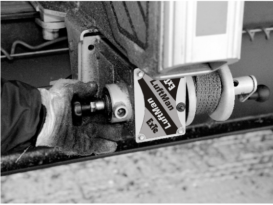
9.1 Frikoppla spännaren och drag ut surringsslinget
