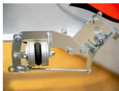
L'avantage du déclencheur pneumatique est que le conducteur n'a pas besoin de faire le tour du véhicule pour défaire les arrimages l'un après l'autre. Les arrimages peuvent être défaits simultanément soit depuis la cabine, soit à l'aide de la télécommande. Le désarrimage terminé, la sangle s'enroule automatiquement. Simple et pratique. Pour désarrimer à un seul endroit, on peut toujours utiliser le déclencheur à câble. Le déclencheur se monte rapidement sur le berceau dans les trous prépercés.
