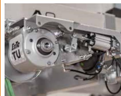
Le détenteur pneumatique se monte en juxtaposition directe avec le tendeur. Avant de sangler la pile, le mécanisme du tendeur se débloque pour permettre le levage au moyen d'une grue ou d'un grappin. Le désarrimage peut se faire soit d'un simple geste depuis la cabine, soit au moyen de la télécommande. Rapide, pratique et sûr.
