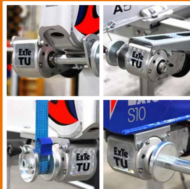
Des fixations existent pour permettre le montage du tendeur TU aussi bien sur le berceau que sur le châssis. À chaque type de berceau correspond différentes fixations.
