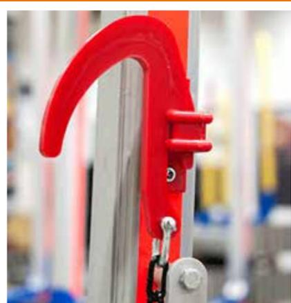
Le crochet est conçu pour être facilement soulevé avec le grappin. Le crochet et le support sont en caoutchouc spécial résistant. Le support est facile à assembler sur le rancher et sa conception assure une position ferme du crochet même pendant la conduite. Le crochet est une solution qui respecte le corps et augmente la sécurité tout en rendant le sanglage plus rapide.
